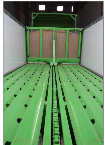
*DRAKKAR CATENA®: beim Entladen ermöglicht die Hilfskette die Verdoppelung der Förderleistung und die Plexiwand bietet eine hervorragende Sicht auf die Ladung.*
